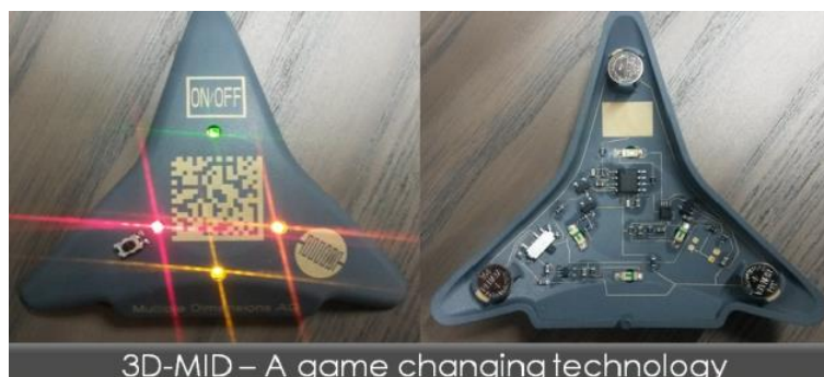
3D-MID Demonstrator: Links die Beleuchtung und den kapazitiven Schaltern (Frontansicht). Rechts die elektronische Schaltung direkt auf dem Kunststoff integriert (Rückansicht).
